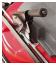
Die Schnitthöhenverstellung kann vom Fahrersitz aus bequem eingestellt werden
