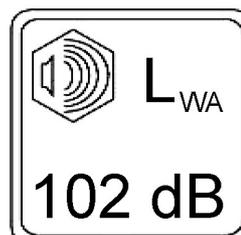
Garantierter Schalleistungspegel nach Richtlinie 2000/14/EG
